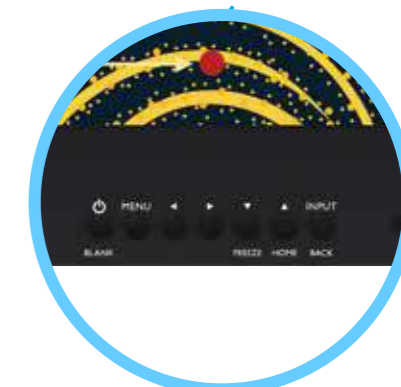
Touches de raccourcis pour le contrôle du volume et la source d'entrée et pour des fonctions qui aident à ramener l'attention des étudiants vers l'enseignant : Blank pour assombrir l'écran Freeze pour mettre l'écran en pause
